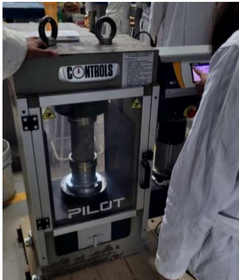
Fig. 21. Prensa hidráulica de la marca CONTROLS, modelo 50-C43C04. Fuente: elaboración propia.
