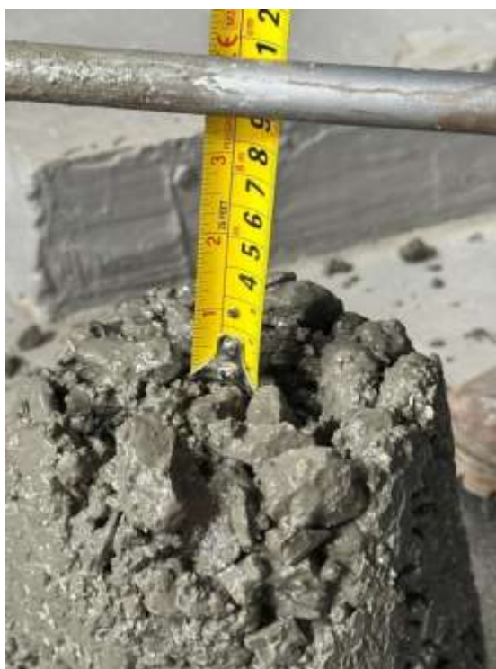
Fig. 27. Revenimiento de la combinación 1. Fuente: Elaboración propia.
