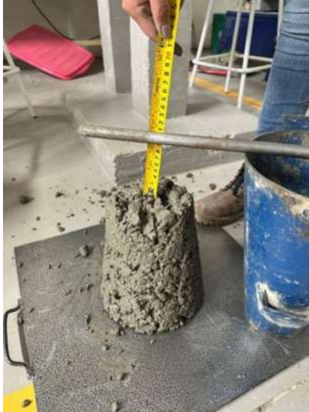
Fig. 28. Revenimiento de la combinación 2. Fuente: Elaboración propia.
