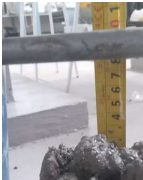
Fig. 26. Revenimiento de la mezcla en blanco. Fuente: Elaboración propia.
