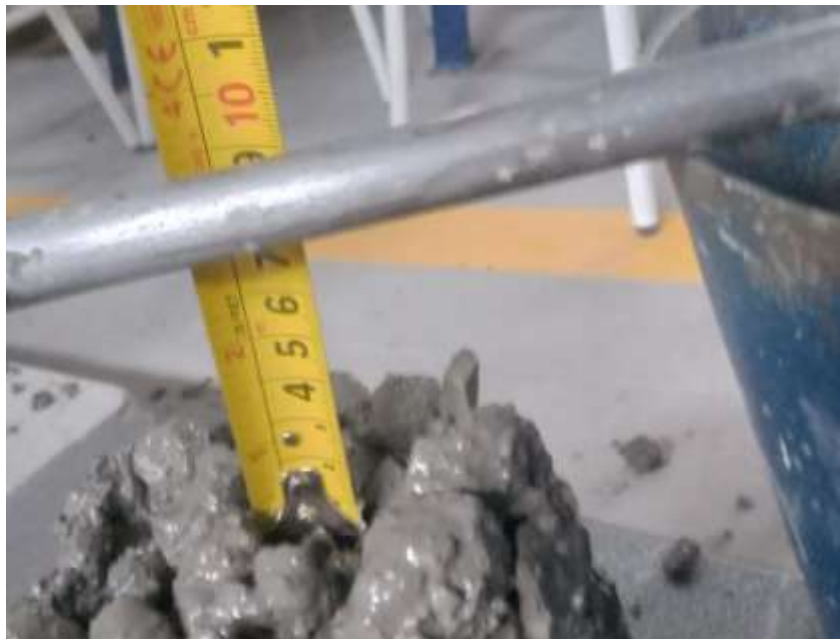
Fig. 29. Revenimiento de la combinación 3. Fuente: Elaboración propia.
