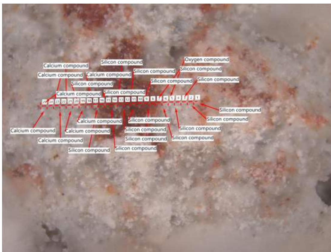
Fig. 49. Distribución de los puntos de análisis de la composición química en la zona 3 de la combinación 1, obtenida mediante microscopía con láser (LIBS), en la que se identifican los compuestos predominantes. Fuente: elaboración propia.
