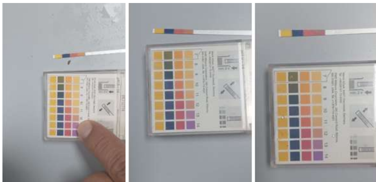
Fig. 36. Resultados de la medición de pH con bandas indicadoras de pH. Fuente: elaboración propia.
