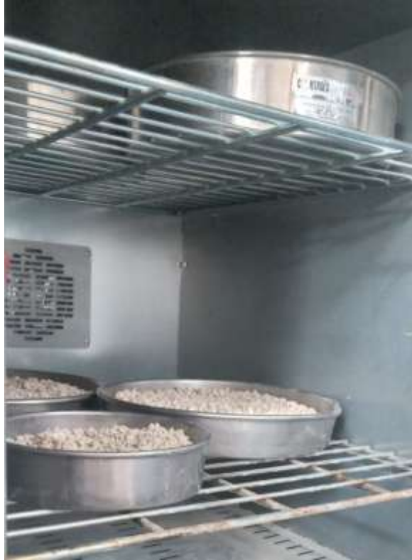
Fig. 24. Secado de agregado en horno de secado. Fuente: Elaboración propia.
