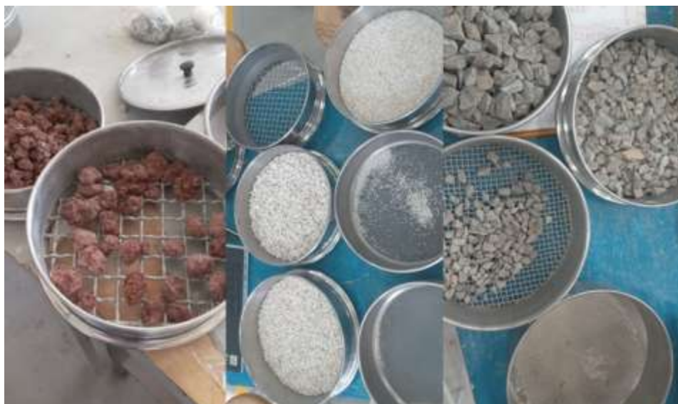
Fig. 22. Pruebas granulométricas de tezontle, aragonita y caliza. Fuente: Elaboración propia.
