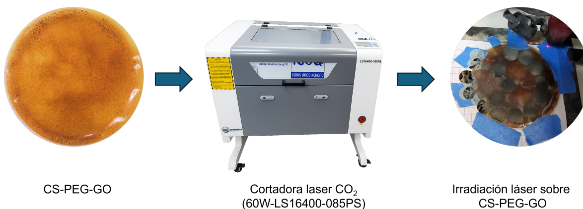
Figura 2.7: Reducción fototérmica inducida por láser en la matriz CS-PEG-GO para la formación localizada de CS-PEG-LrGO en la zona irradiada.
