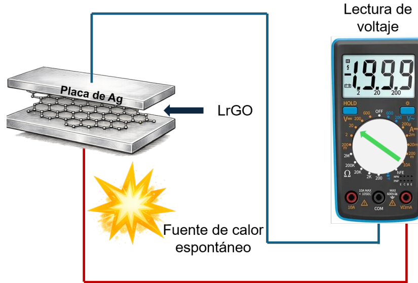
Figura 1.10: Esquema de la transducción piroeléctrica en LrGO.
