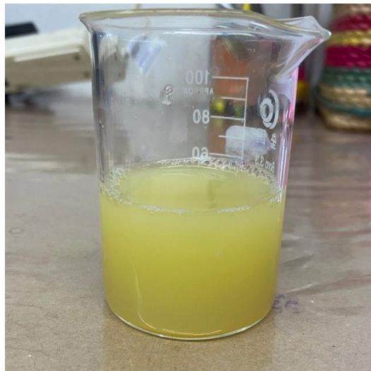
Figura 9. Extracción de queratina por método alcalino.
