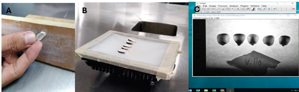
Figura 13, Prosesamiento de imagenes A) Lijado. B) Toma de fotografías. C) Procesamiento de imagen con el programa Image J Versión 1.53.
