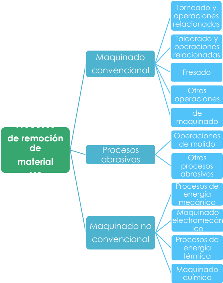
Figura 2.12 Clasificación de los procesos de manufactura sustractiva o de remoción. Fuente: Adaptado de Groover (2007, p. 482).
