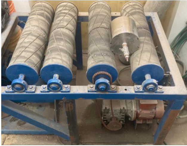
Figura 8. Mesa de rodillos giratorios y molino horizontal de bolas.
