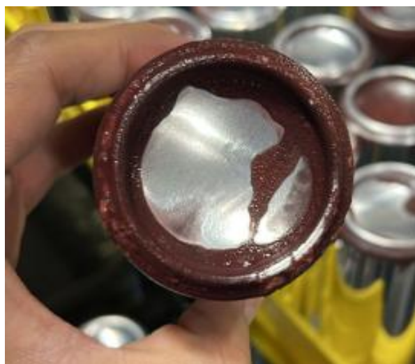
Figura 35 Mala aplicación de barniz UV.
