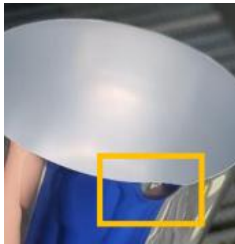
Figura 27 Golpe de la hold down o transfer.
