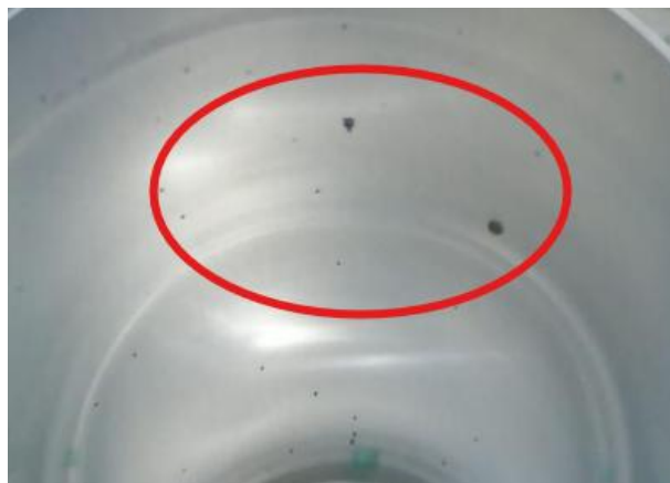
Figura 38 Contaminación de barniz exterior
