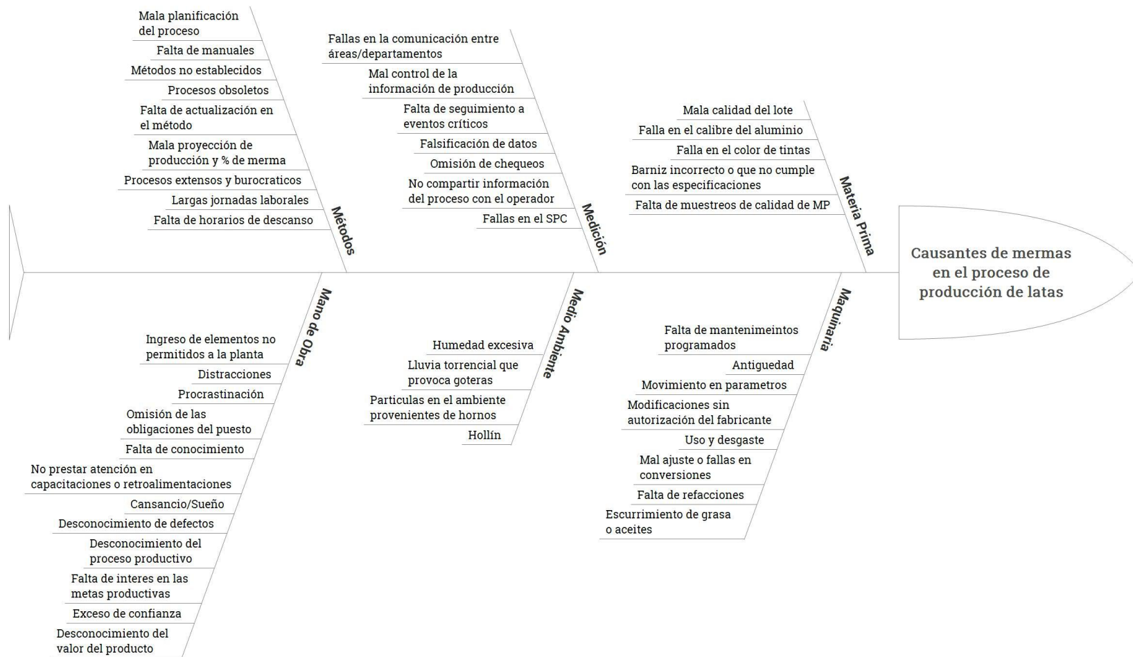
Figura 71 Representación de las causas-efectos de las mermas de un proceso por medio de un Diagrama Ishikawa
