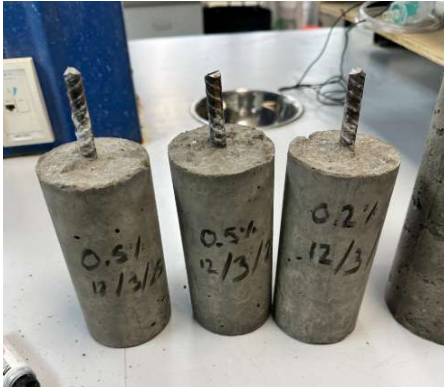
Fig. 10. Especímenes para pruebas de potenciales de media celda con el 0.5% de goma. Fuente: elaboración propia.
