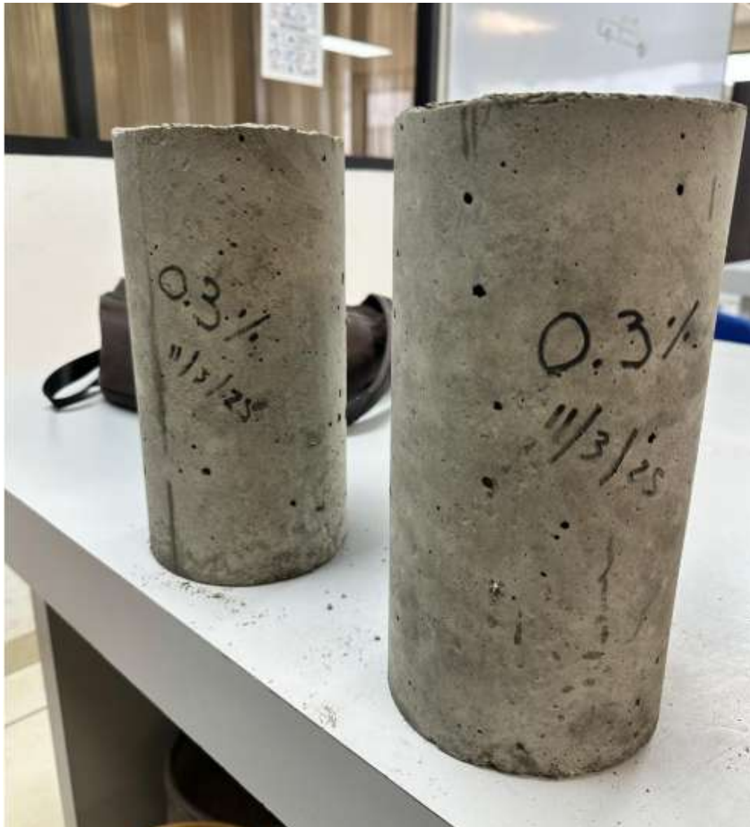
Fig. 9. Cilindros para prueba de compresión, con 0.3% de Goma. Fuente: elaboración propia.
