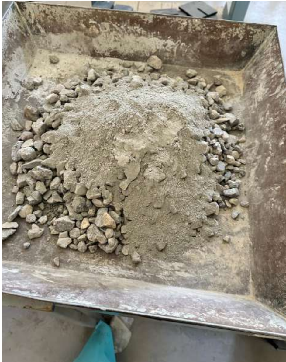
Fig. 8. Mezcla de agregados secos con goma. Fuente: Elaboración propia.
