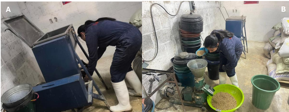
Figura 3. Elaboración de alimento. A. Mezclado de ingredientes. B. Peletizado de alimento.
