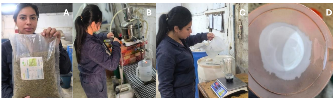
Figura 1. Elaboración de emulsión de tomillo ( Thymus vulgaris ). A. Obtención de tomillo. B. Elaboración de hidrolato de tomillo. C. Integración de hidrolato de tomillo, aceite de soya y tween. D. Obtención de emulsión de tomillo.
