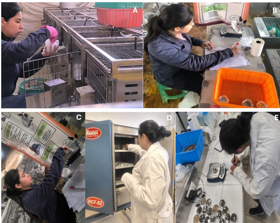
Figura 5. Proceso para evaluar la digestibilidad. A. Recolección e identificación de muestra. B. Peso de toda la muestra. C. Pesos de charolas y registro. D. Colocación de muestras en el horno. E. Registro los pesos de la materia seca.
