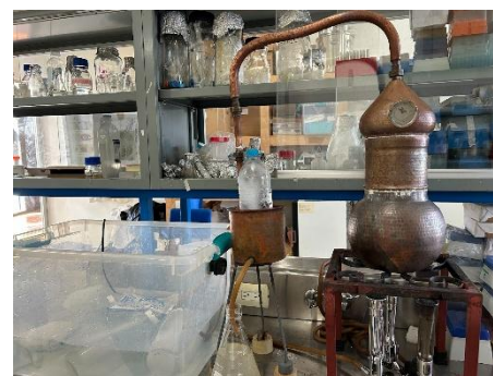
Figura 6. Alambique para la extracción por arrastre de vapor
