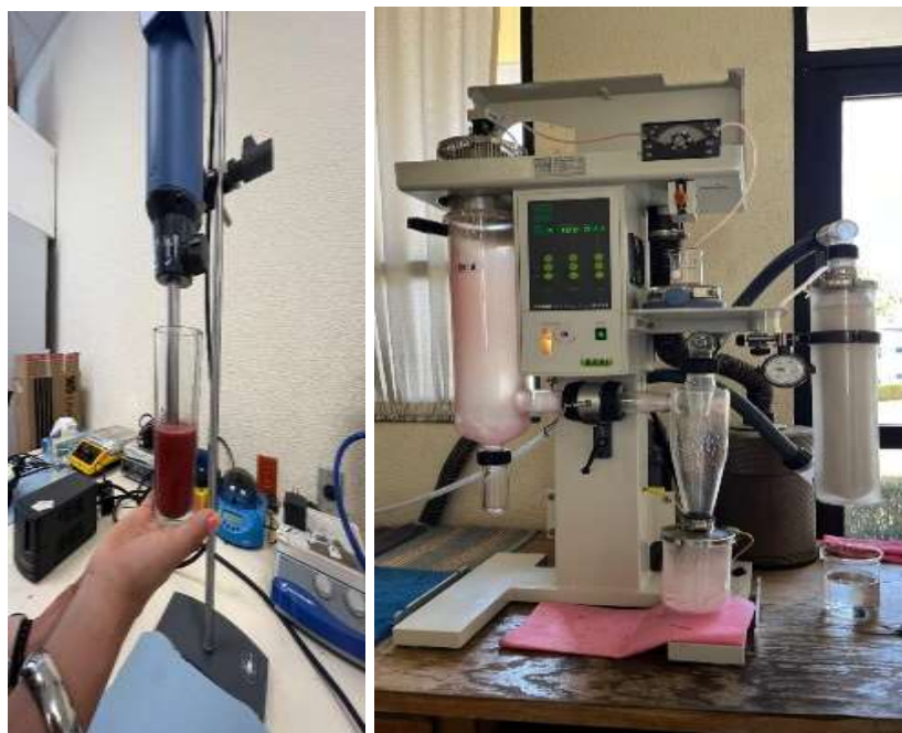
Figura 9. Proceso de microencapsulación de extracto por secado por aspersión en secador Buchi B-191.
