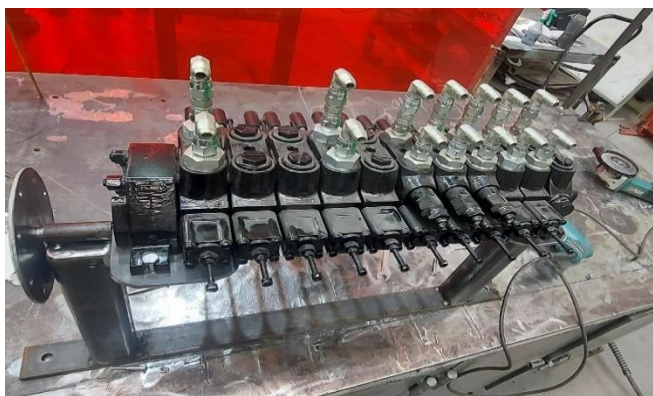
Figura 3.8 Dispositivo para el armado del distribuidor
