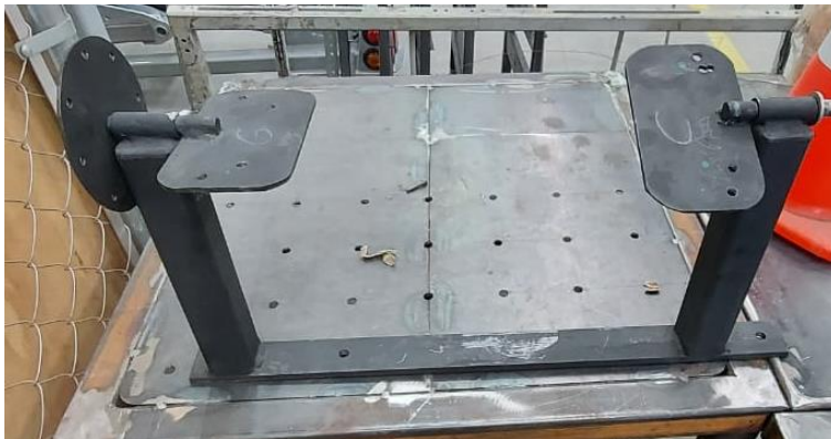
Figura 3.7 Dispositivo para el armado del distribuidor.
