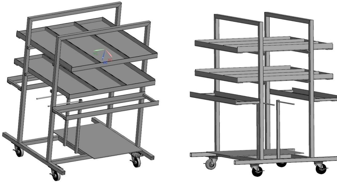
Figura 3.14 Diseño de carrito en 3D para el producto terminado
