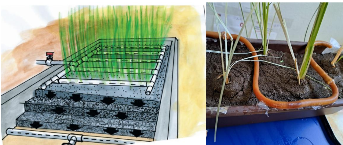
Figura 13. Humedal artificial de flujo subsuperficial horizontal. Fuente: Rivas (2022), Elaboración propia (2025).
