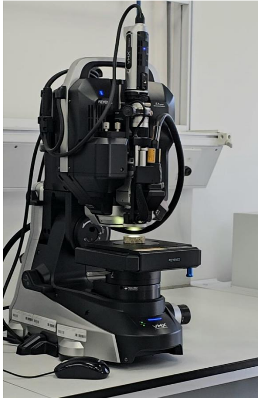
Ilustración 21. Sistema de espectroscopía de ruptura inducida por láser (LIBS) Keyence EA-300 acoplado a microscopio digital de alta resolución.
