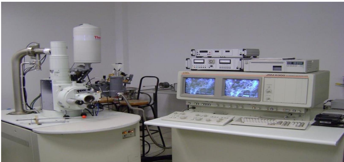
Ilustración 15. Microscopio electrónico de barrido JEOL JSM-6300 equipado con detector EDS.
