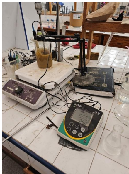
Figura 26 Precipitación de AU y Li_2CO_3
