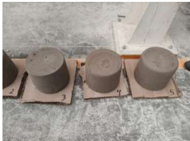
Figura 20. Probetas de concreto Celular Autoclaveado con adición de jales en distintas proporciones, listas para Prueba de Resistencia a la compresión, Obtenida por el Autor
