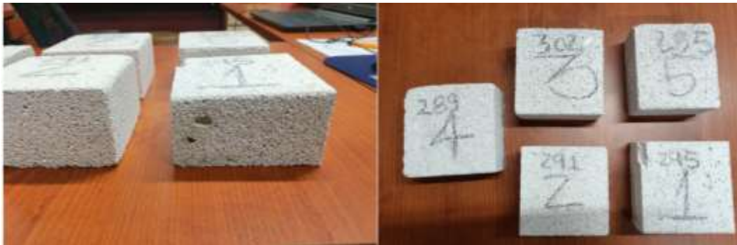
Figura 19. Obtención de bloques como producto final de concreto Celular Autoclaveado con adición de Jales en distintas proporciones, Obtenida por el Autor
