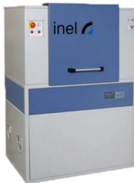
Figura 8 Difractómetro marca Inel Equinox 3000 Fuente: Universidad Autónoma del Estado de Hidalgo.
