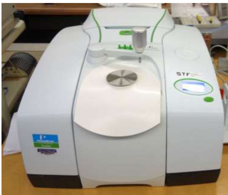
Figura 9. Espectrómetro modelo Frontier FTIR, marca Perkin Elmer (Waltham, MA, EE. UU.) Fuente: Universidad Autónoma del Estado de Hidalgo.
