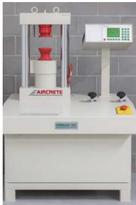
Figura 12. Prensa de compresión Marca TEST-FORM, utilizada para determinar la resistencia a la compresión de bloques de concreto celular autoclaveado (AAC). Propiedad de la empresa AIRCRETE de México.
