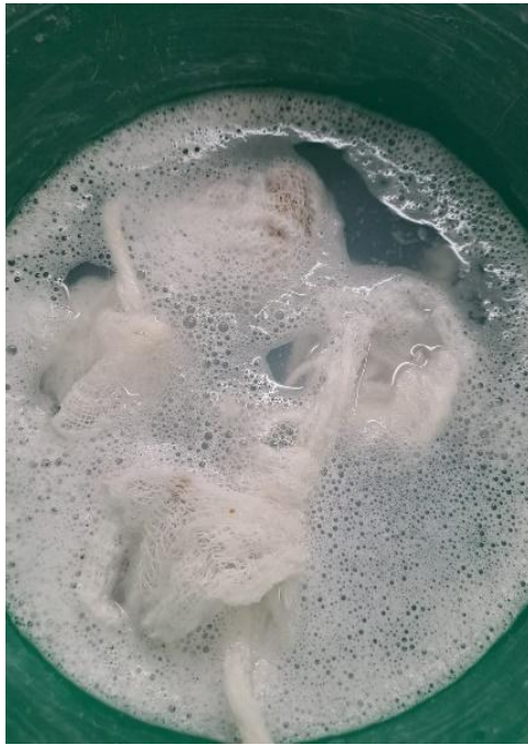
Figura 11. Proceso de blanqueamiento dentro de la solución con peróxido de hidrógeno ( H_2O_2 ).
