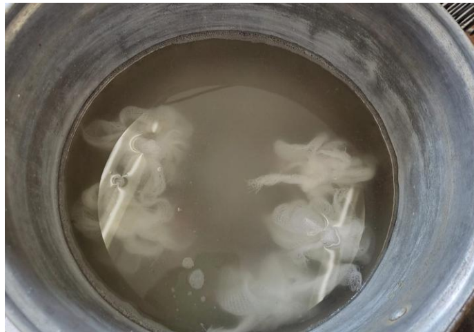
Figura 9. Etapa de cocción en una solución compuesta por agua e hidróxido de amonio ( \text{NH}_4\text{OH} ) dentro de un recipiente metálico.
