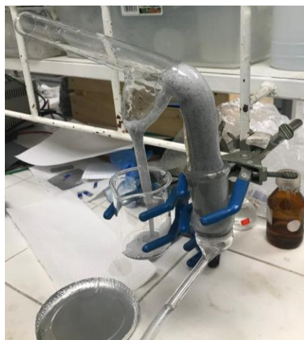
Figura 6. Esquema de la celda de microflotación utilizada para la concentración de las especies de interés de la escoria.
