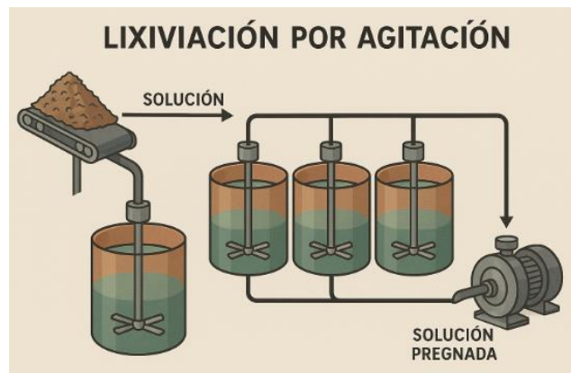
Figura 4. Esquema que muestra la Lixiviación por agitación
