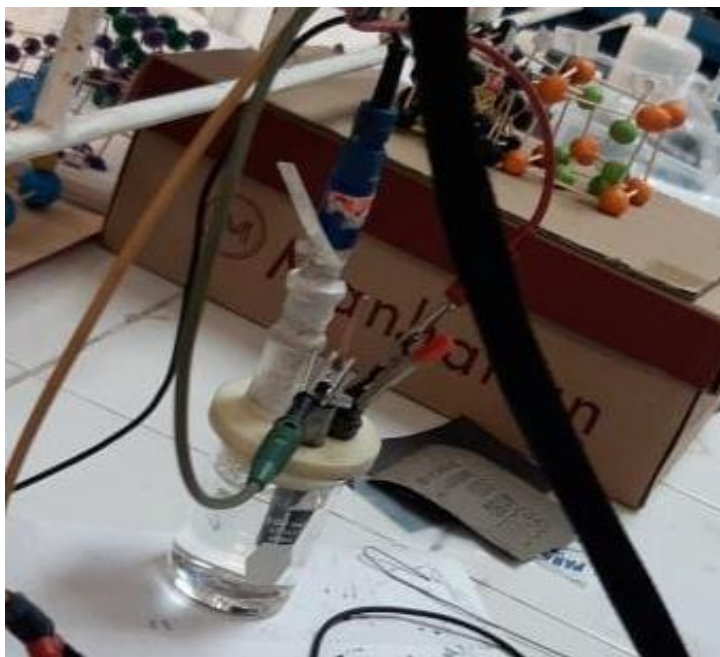
Figura 7. Esquema que muestra la celda electroquímica.
