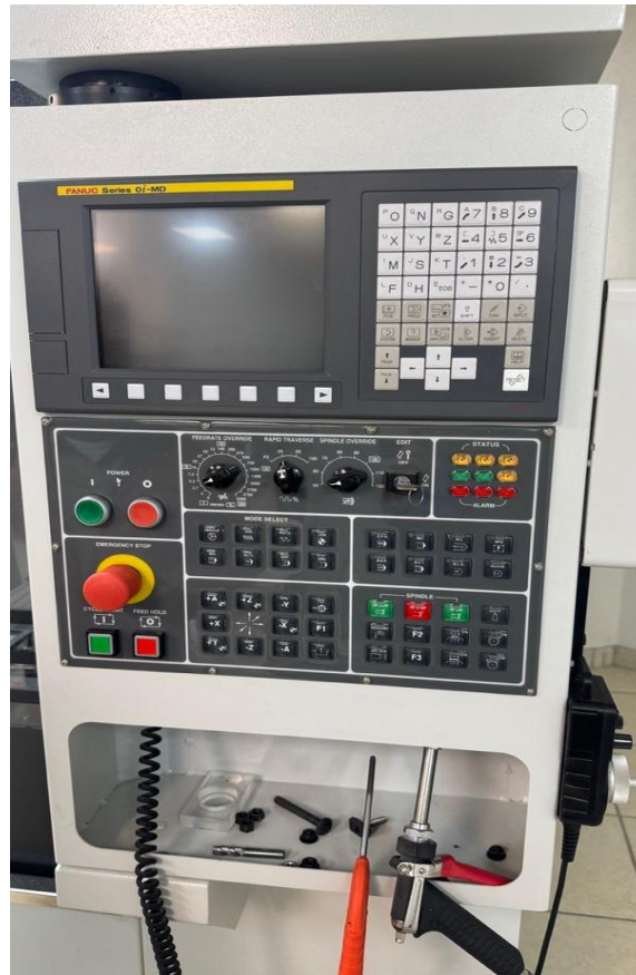
Ilustración 10. Panel de controles y botones de la fresadora SunMill JHV 550. Nota. Elaboración Propia, fotografía tomada en el laboratorio de manufactura de la UAEH.
