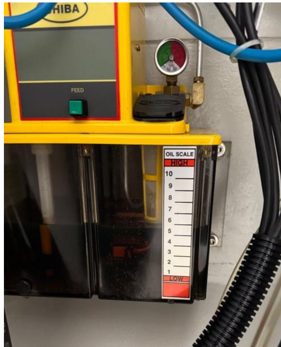
Ilustración 5. Depósito de aceite de lubricación de la fresadora SunMill JHV-550. Nota. Elaboración Propia, fotografía tomada en el laboratorio de manufactura de la UAEH.
