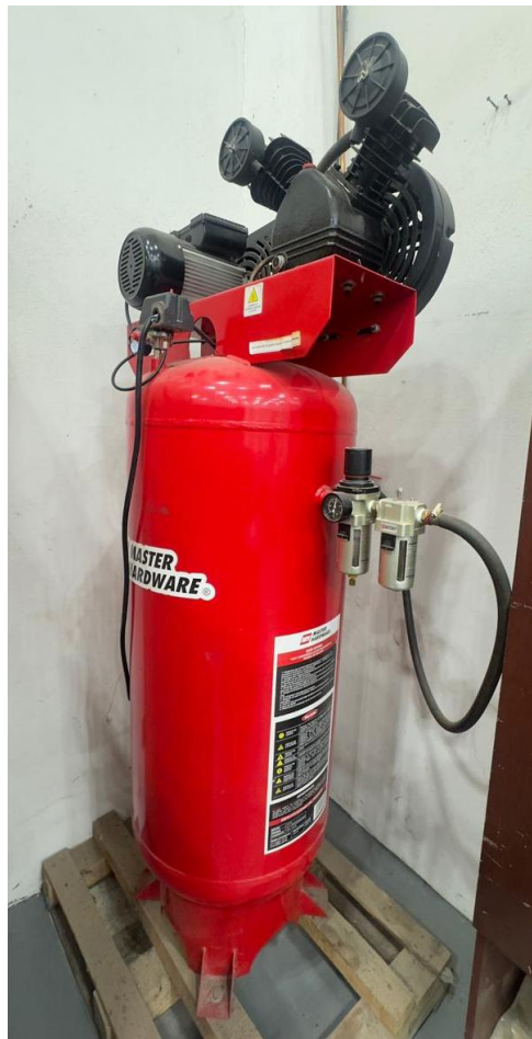
Ilustración 4. Compresor de aire utilizado para el funcionamiento de la fresadora. Nota. Elaboración Propia, fotografía tomada en el laboratorio de manufactura de la UAEH.
