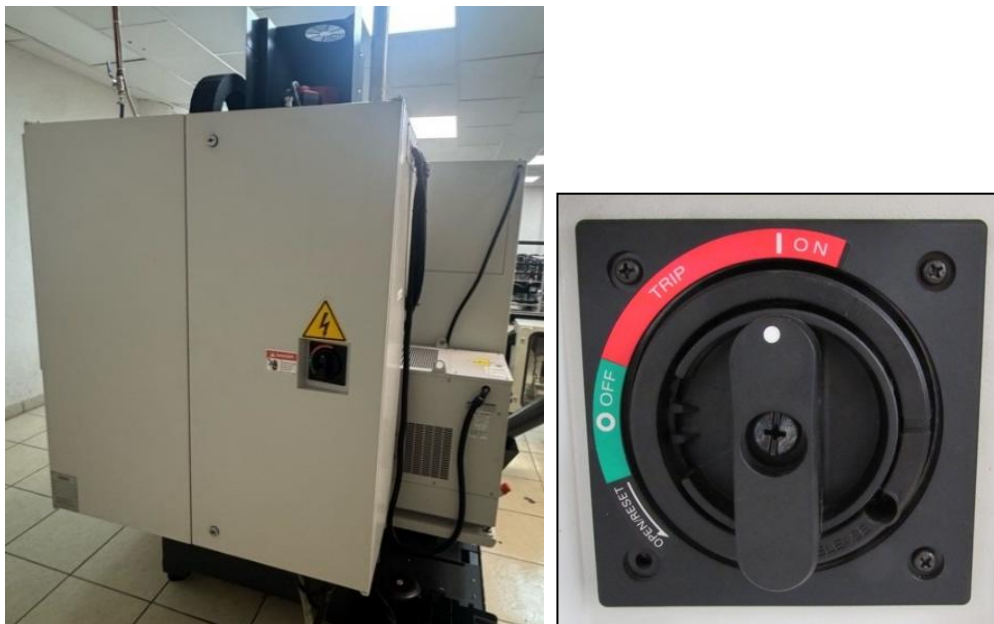
Ilustración 3. Botón de encendido de la fresadora SunMill JHV-550 Nota. Elaboración Propia, fotografía tomada en el laboratorio de manufactura de la UAEH.
