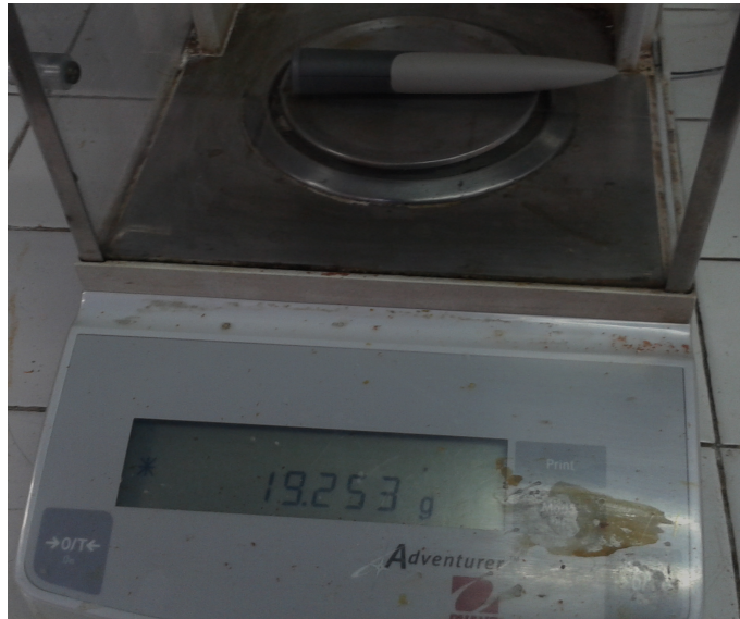
Figura 4.16: Masa del dedal implementado para experimentación.
