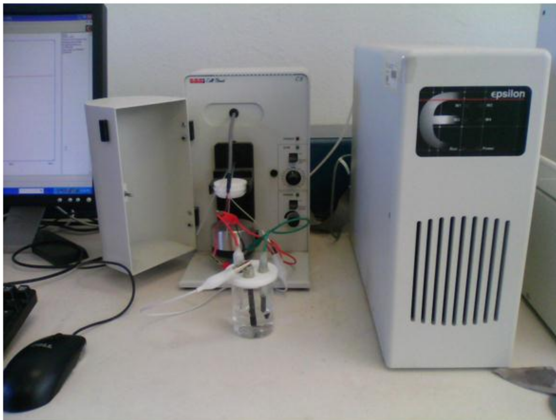
Figura 3.1 Imagen de la celda electrolítica que contiene la solución de 0.01M \text{ZnCl}_2 + 1M \text{NH}_4\text{Cl} a pH 6.
