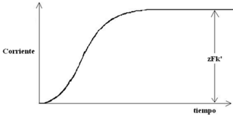
Figura 2.5 Transitorio potencioestático teórico correspondiente a la nucleación y crecimiento tridimensional instantáneo limitado por la incorporación de átomos a los centros de crecimiento.
