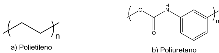
Figura II. 3 Ejemplos de estructuras de polímeros de acuerdo a su comportamiento térmico a) Termoplástico y b) Termoestable
