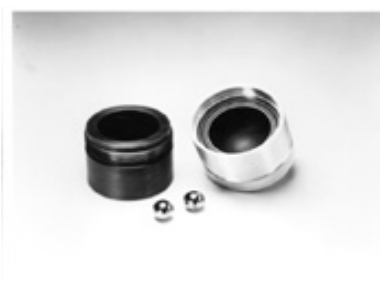
Figura II.2. Contenedores de acero grado herramienta D2 con balines de acero al carbón cementado.
