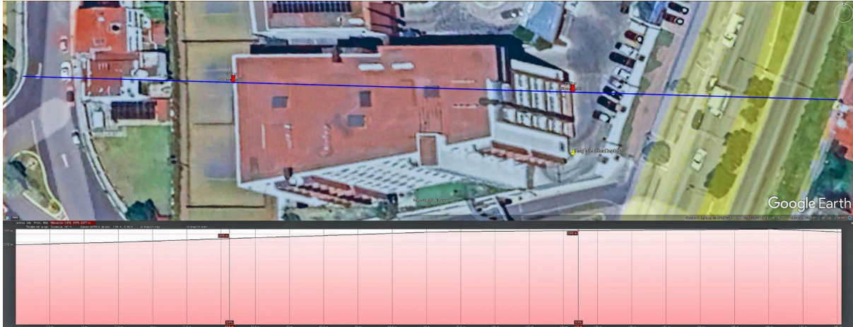
Figura 1.4. Curvas de nivel y perfil topográfico del sitio donde se emplaza la Torre 2 del Complejo Altea Luxury & Living. Fuente: Elaboración propia con base en Google Earth.
