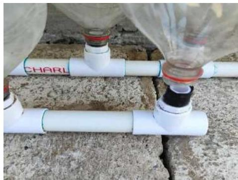
**Figura 25.** Colocación de botellas en la base
