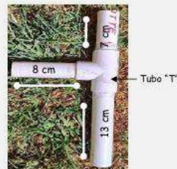
20 Introducir el segmento de 8 cm en el orificio más bajo en la cubeta (realizado en el paso 18), colocando el segmento más largo de PVC hacia abajo y pegar completamente el tubo "T" de PVC a la cubeta.
