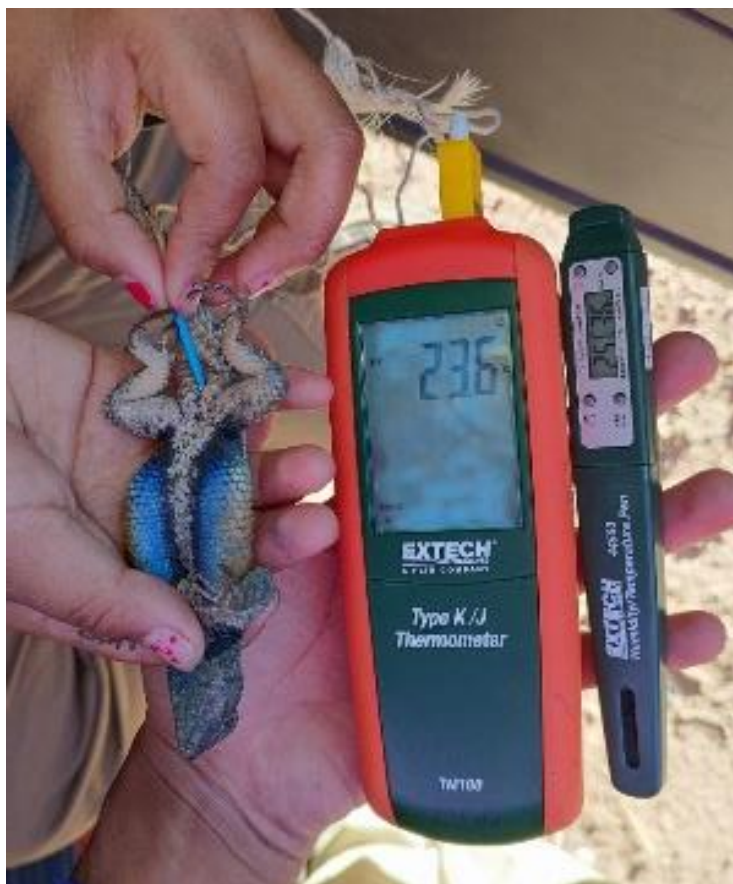
Figura 2. Obtención de datos de 1) temperatura corporal: introduciendo la sonda del termómetro digital en la cloaca de la lagartija, y 2) temperatura ambiental: mediante un termohigrómetro a una altura de 1 metro desde el suelo.
