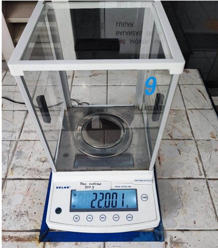
Figura 10. Balanza electrónica de precisión utilizada para pesar los componentes.
