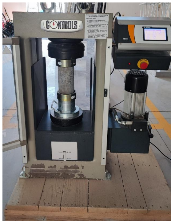
Figura 19. Máquina de ensaye a compresión de cilindros de concreto.
