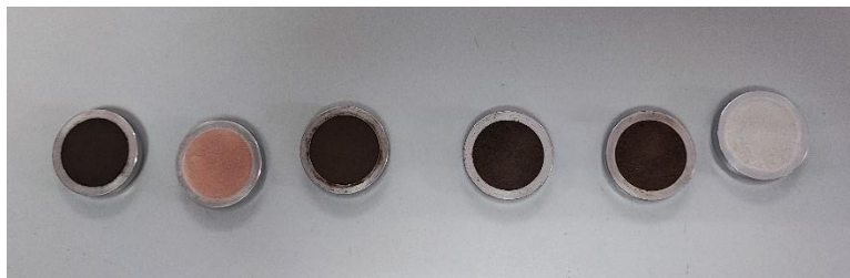
Figura 21. Muestras de jal de manganeso, cemento y riolita para análisis por Difracción de Rayos X.
