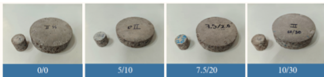
Figura 18. Muestras de concreto de 29 mm y 100 mm de diámetro utilizadas en el ensayo acústico.
