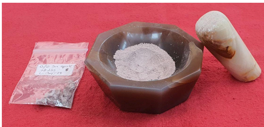
Figura 14. Preparación de las muestras de concreto para análisis DRX, molienda en mortero de ágata.
