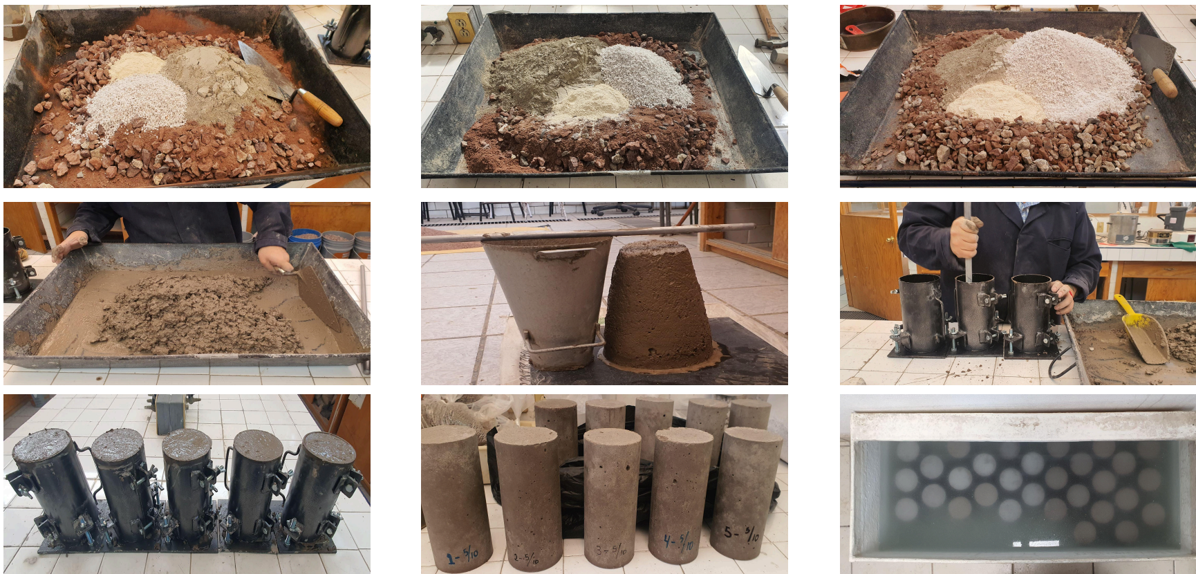
Figura 7. Proceso de elaboración de mezclas y curado de probetas de concreto.
