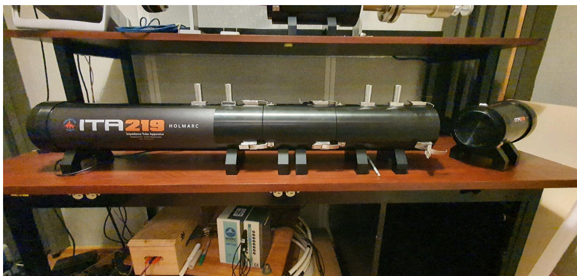
Figura 16. Tubo de impedancia HOLMARC modelo ITA-219 utilizado para la caracterización acústica del concreto.
