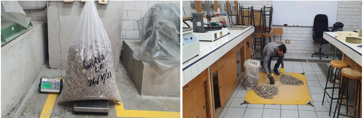
Figura 2. Reducción de muestras de ACR mediante método de cuarteo (NMX-C-170).
