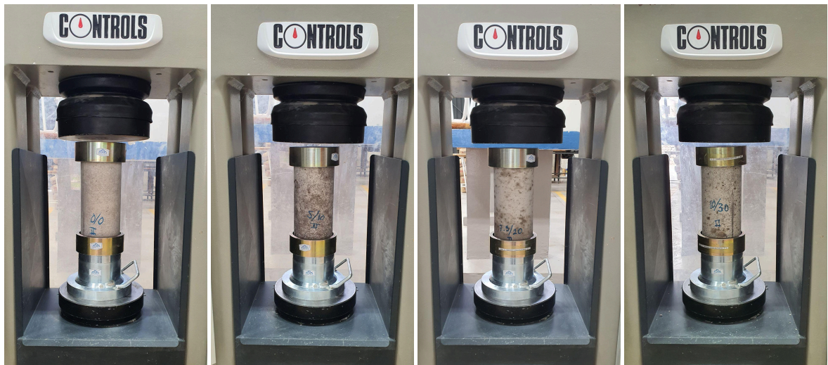
Figura 10. Ensayo mecánico de resistencia a la compresión en probetas de dosificaciones seleccionadas.
