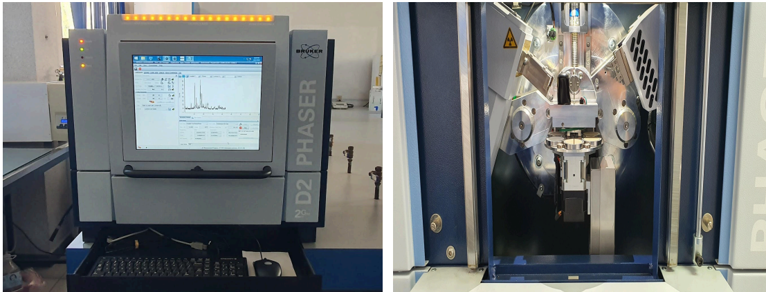
Figura 4. Difractómetro de Rayos X BRUKER D2 PHASER A26 utilizado en el análisis.
