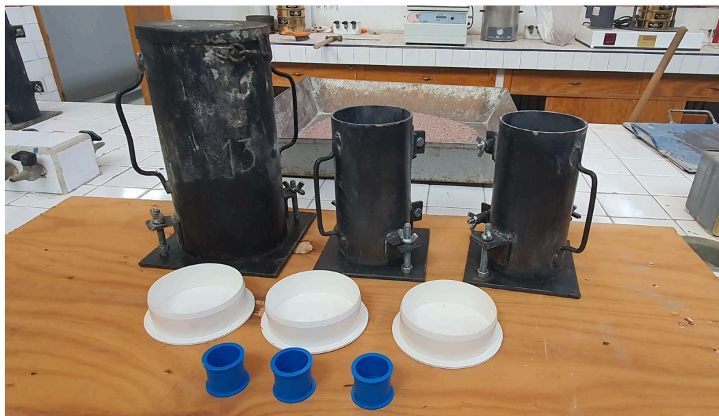
Figura 9. Moldes cilíndricos empleados en la elaboración de probetas de concreto. Moldes de acero (negros), de PVC 4" (blancos) y de PETG (azules).
