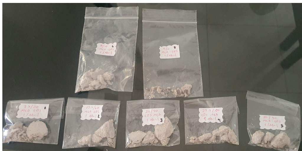
Figura 11. Muestras recolectadas de las fracturas de probetas ensayadas a compresión para análisis DRX y MEB-EDX.
