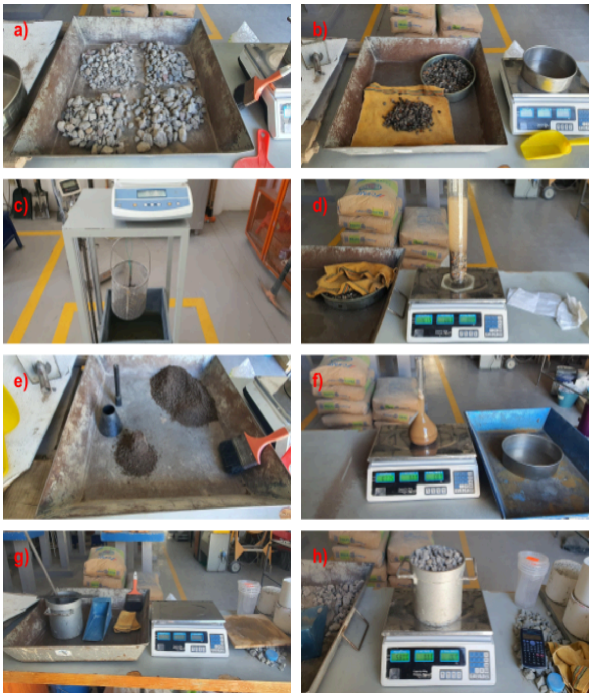
Figura 3. Determinación de la densidad relativa, porcentaje de absorción y peso volumétrico de ACR.
