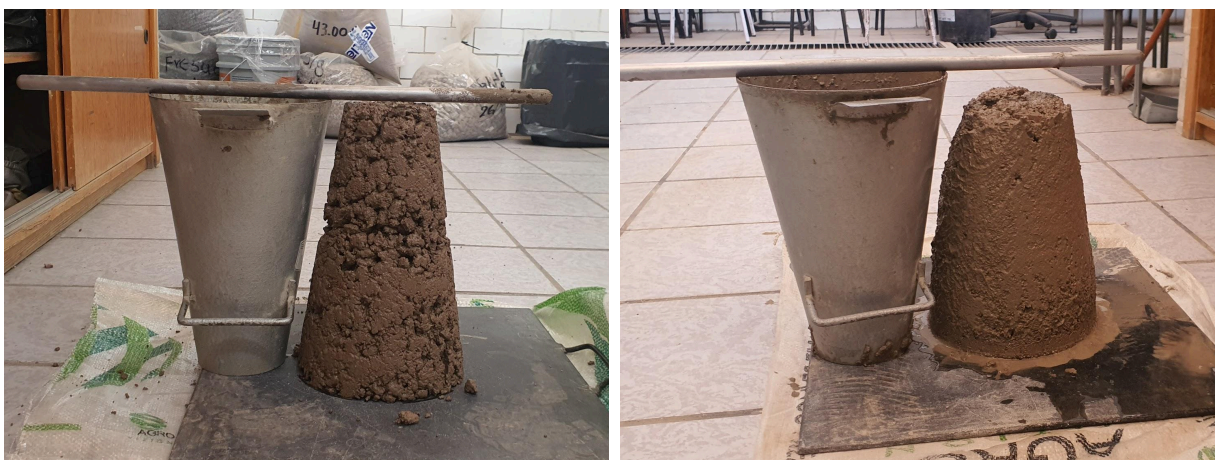
Figura 31. Ajuste de agua en mezclas de concreto (prueba de revenimiento).
