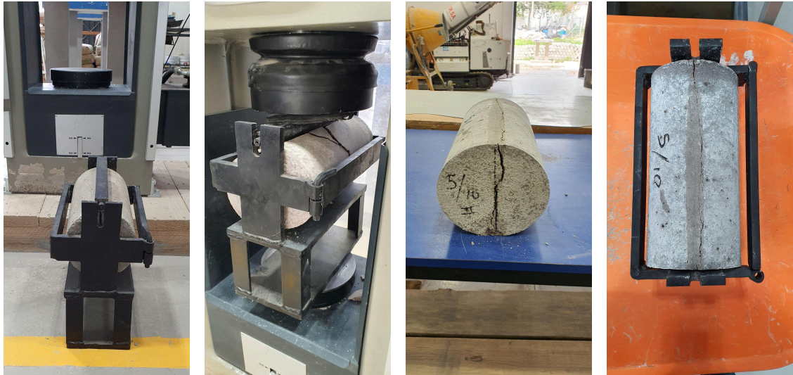
Figura 13. Ensayo de resistencia a la tracción indirecta (prueba brasileña).
