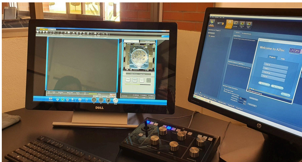
Figura 15. Sistema de control y software de adquisición de datos del microscopio electrónico de barrido JEOL IT-300.
