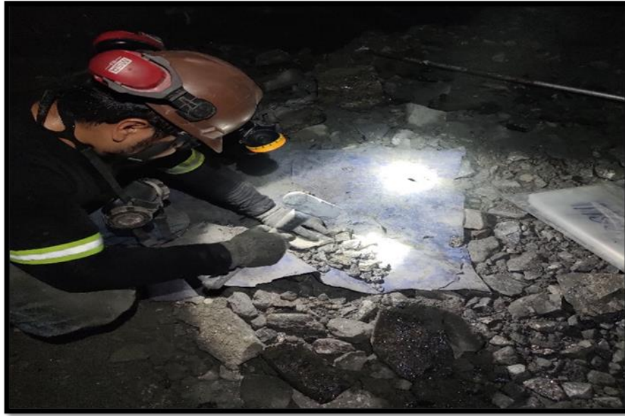
Imagen 38. Trituración de muestra
