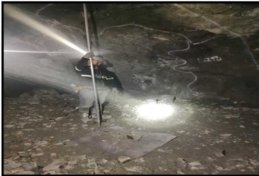
Imagen 37. Lona debajo de la muestra a tirar
