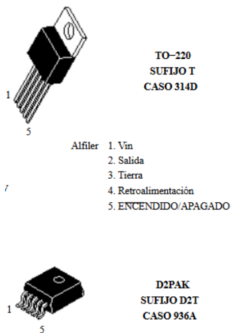
Figura 1. Circuito integrado usado Enel LM2596 [24].
