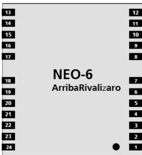
Figura 10. Disposición de pines en el NEO-6 [25].
