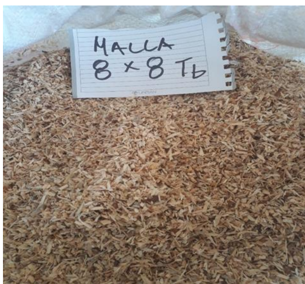
Figura 6 Granulometría del aserrín crudo resultante del tamizado con la malla de 2.7 mm.
