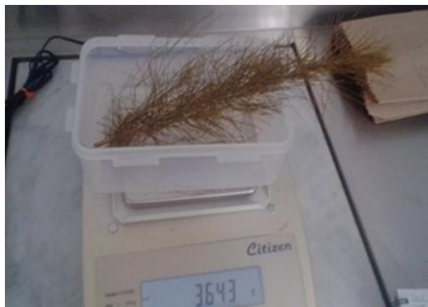
Figura 27 Determinación del peso seco de la parte aérea (biomasa) mediante el uso de una balanza analítica de precisión.
