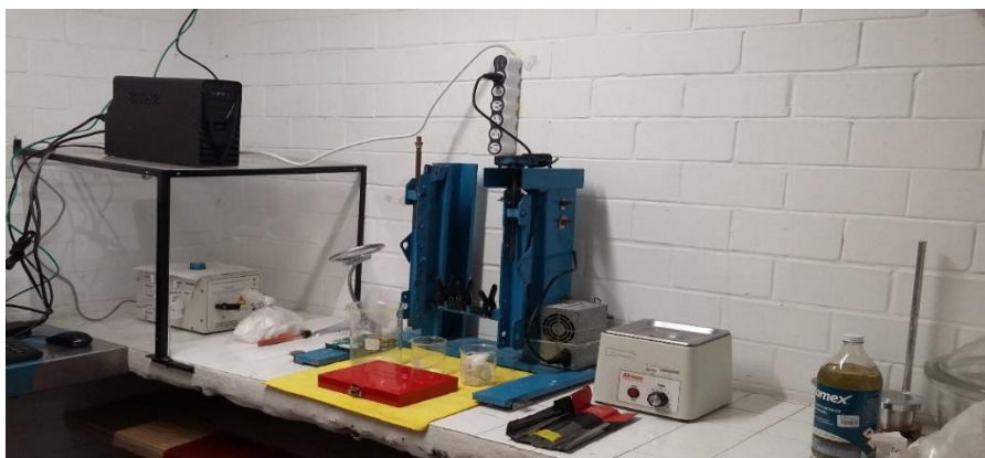
Figura 13. Montaje del dispositivo de inmersión eléctrica para la técnica de Dip-coating.
