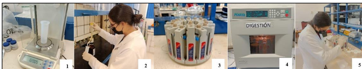
Figura 2. Pasos metodológicos para la digestión ácida de las muestras (1 pesaje de muestras, 2 vaciado de ácido nítrico, 3 carrusel con muestras y 4 muestras en digestión y 5 almacenamiento de muestras).
