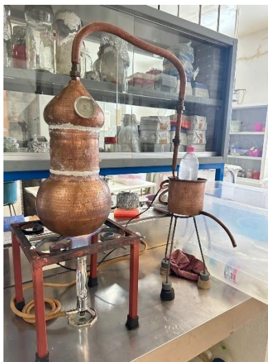
Figura 6. Extracción de aceite esencial por arrastre de vapor.
