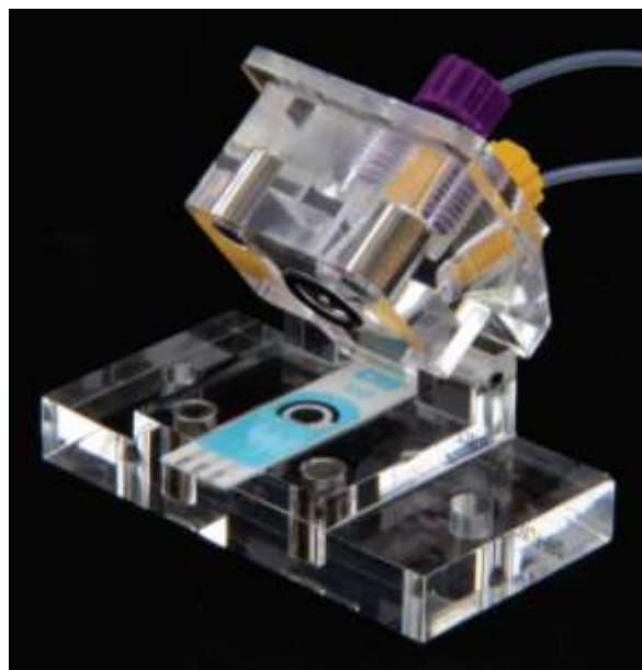
Figura 11. Celda electroquímica para análisis en flujo, a) electrodo serigrafiado de carbono, b) celda de choque frontal de metacrilato para análisis en flujo [54].
