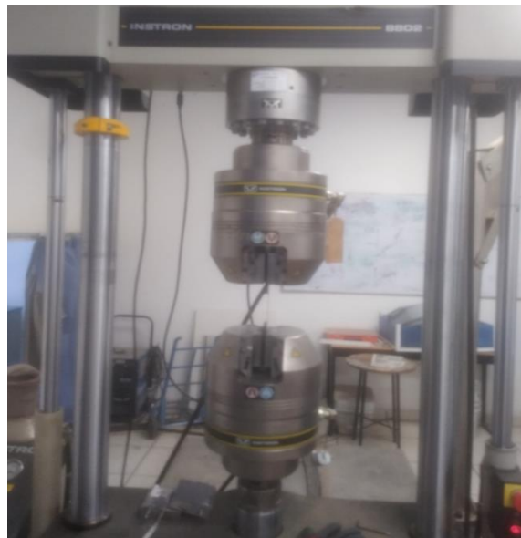
Figura 26. Máquina INSTRON-8802 utilizada para las pruebas de tensión.
