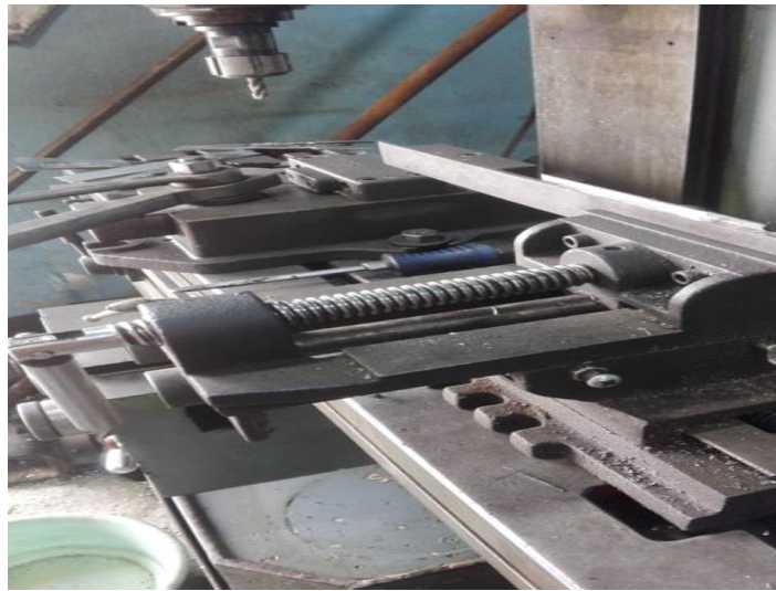
Figura 25. Proceso de maquinado para las probetas de tensión.
