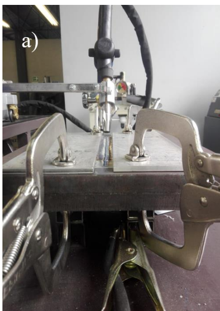
Figura 23. Arreglo experimental para la aplicación semiautomática del proceso GMAW.
