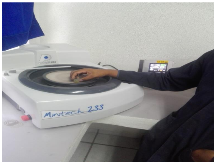
Figura 16. Pulidora PRESI-Minitech 233 utilizada para la obtención de muestras con acabado espejo.
