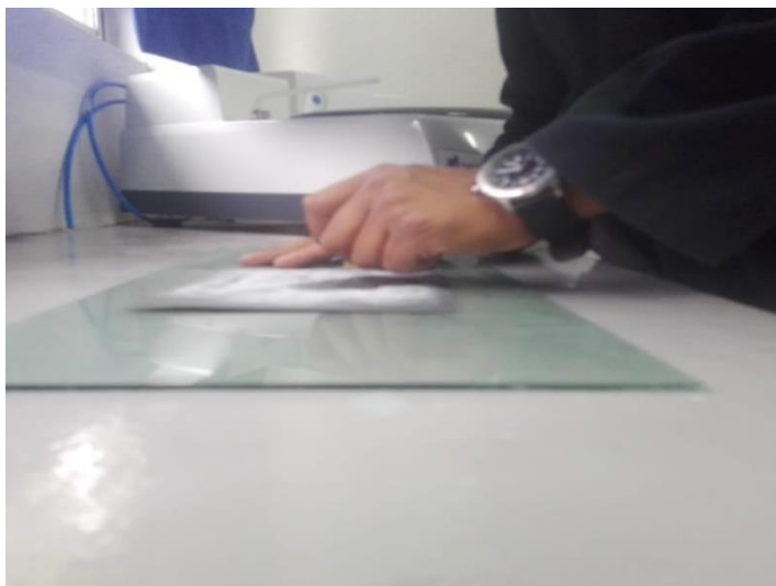
Figura 15. Proceso de desbaste con papel de carburo de silicio.
