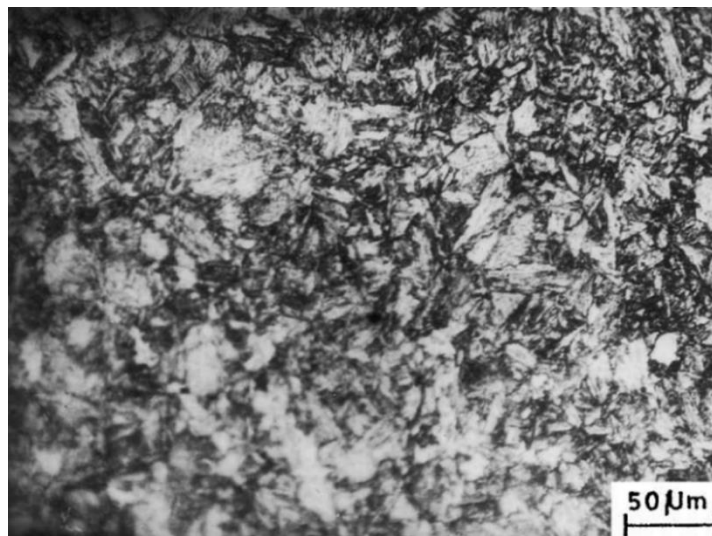
Figura 2. Microestructura de HSLA con bainita acicular (Mohan et al., 2002).
