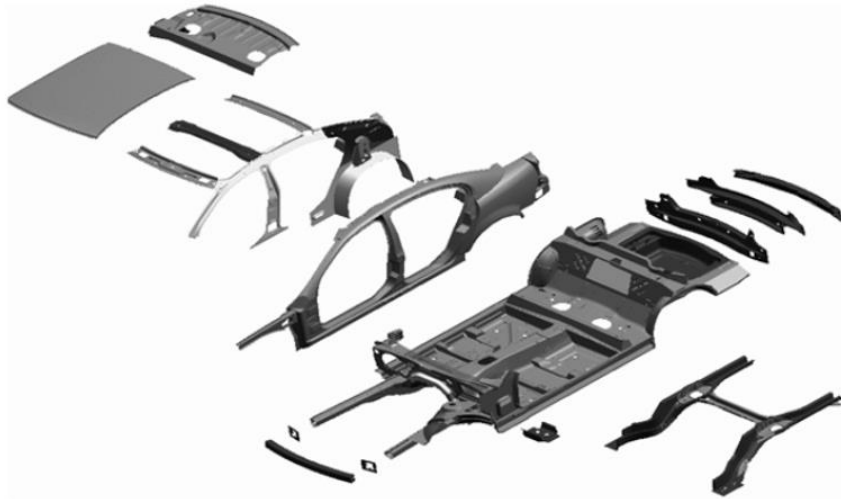
Figura 8. Estructura simplificada de un vehículo (Horvath, 2010).
