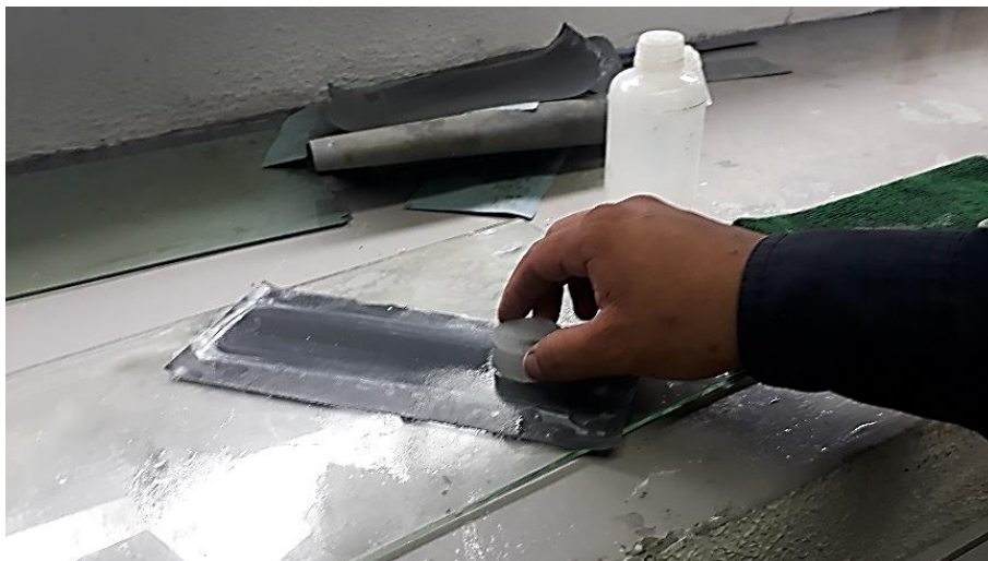
Figura 26. Proceso de desbaste con papel carburo de silicio.
