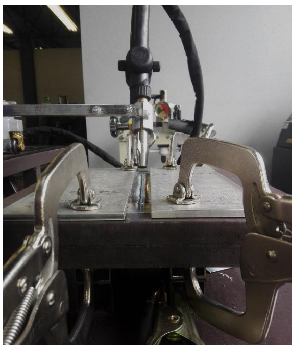
Figura 37. Arreglo experimental para soldadura semiautomática.
