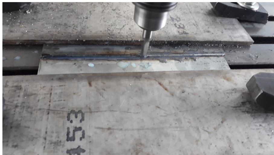
Figura 38. Fresado de cordón de soldadura.
