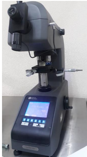
Figura 39. Durómetro utilizado para realizar mediciones de microdureza.
