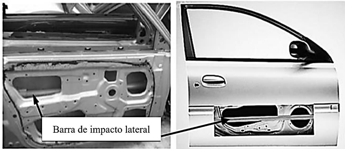
Figura 18. Barra lateral de impacto fabricada en acero TRIP (Nemani & Arakerimath, 2015).
