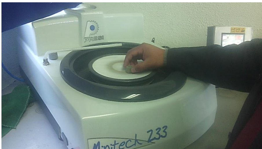
Figura 27. Proceso de pulido de muestras metalográficas.
