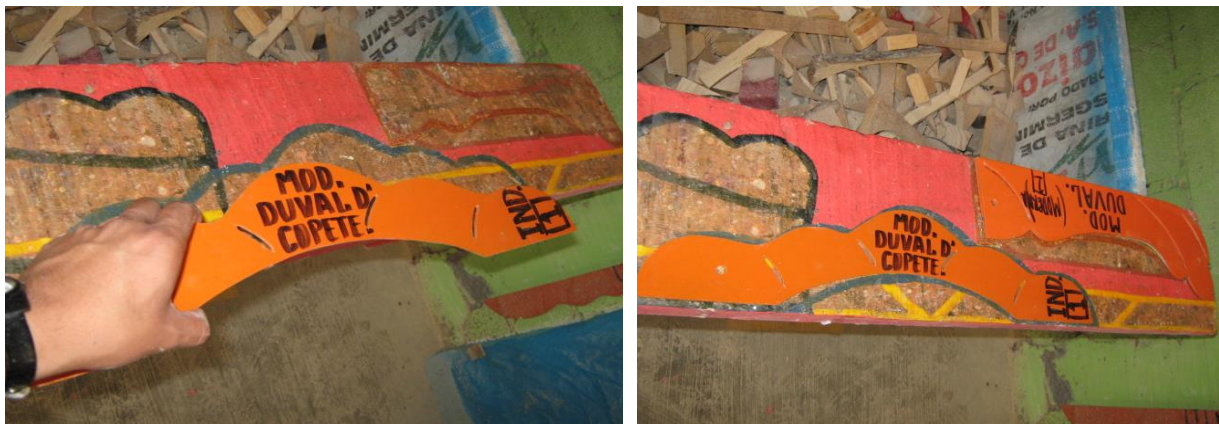
Fig. 31 Colocación de plantillas a prueba de error.
