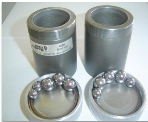
Figura 3.4 Viales de acero endurecido y bolas de acero.
