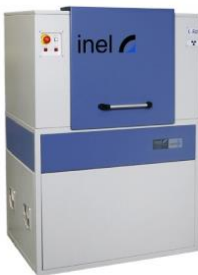
Figura 3.9 Difractómetro de rayos X (24).
