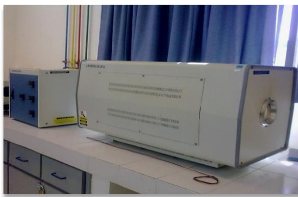
Figura 3.6 Horno tipo mufla tubular de alta temperatura.
