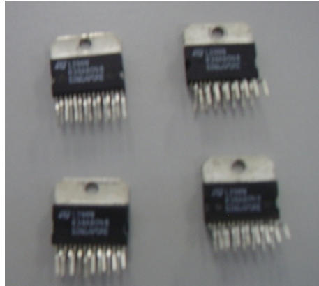
Figura 2.17: Puente H L298.
