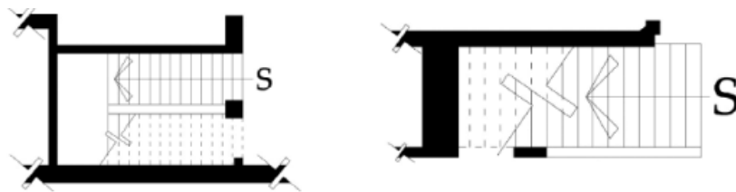
Figura 3. 26. Después del corte la huella se dibujará con línea punteada.
