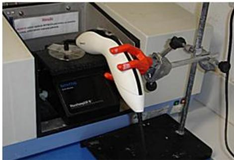
*Figura 12. Imagen de posicionamiento de la lámpara UV, sobre la celda de equipo IR.*
