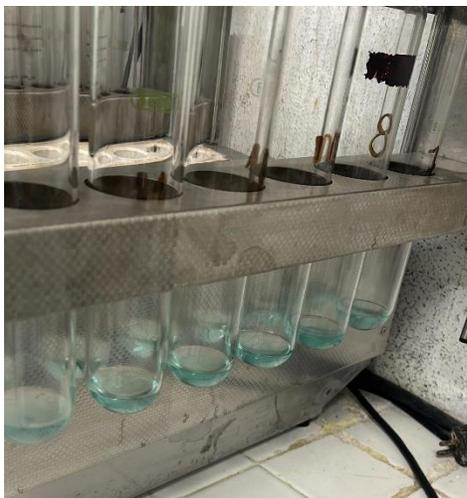
**Figura 4. Equipo utilizado para la determinación proteínica.**
