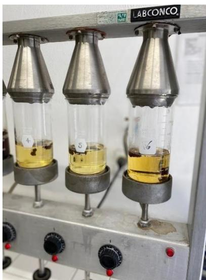
**Figura 6. Equipo utilizado para la determinación de fibra cruda.**
