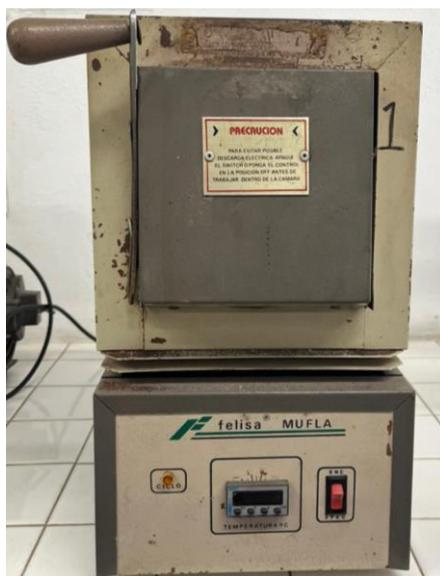
**Figura 5. Equipo utilizado para la determinación de cenizas.**
