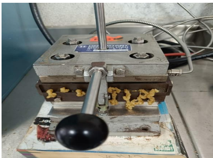
Figura 12. Termopresado de las espumas bioactivas.
