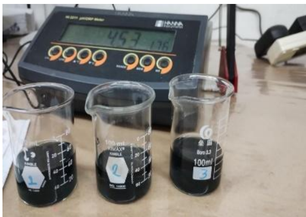
Figura 7. Medición de pH en las muestras de baño residual en un potenciómetro Marca Hanna, Modelo H12211.
