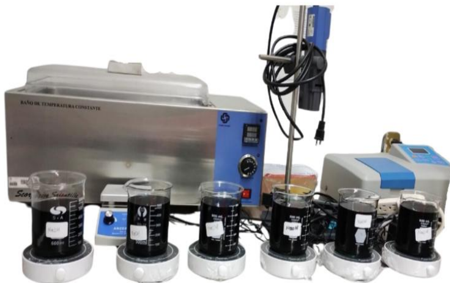
Figura 12. Interacción de agentes precipitantes con las muestras de cromo del método tradicional (MT).
