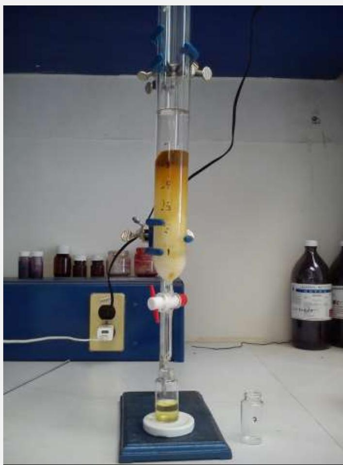
**Figura 27: Cromatografía en columna del EMC.** Se utilizó sílica como fase estacionaria, el extracto de granada impregnado en sílica y como fase móvil solución de cloroformo: metanol a polaridad creciente: 5:1, 4:1, 3:1, 2:1, 1:1 y finalizando únicamente con metanol.
