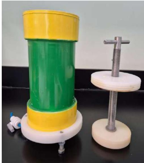
**Figura 2.** Microsilos de PVC. Del lado derecho se observa el tornillo para compresión del material que elimina la mayor cantidad del agua en la muestra.
