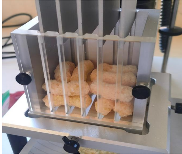
Figura 8. Sonda Kramer de 5 palas (HDP/KS5)
