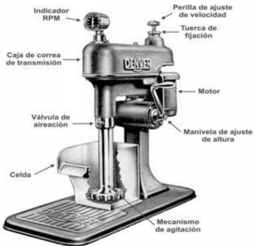
Figura 3.1 Máquina de flotación sub aireada marca Denver.
