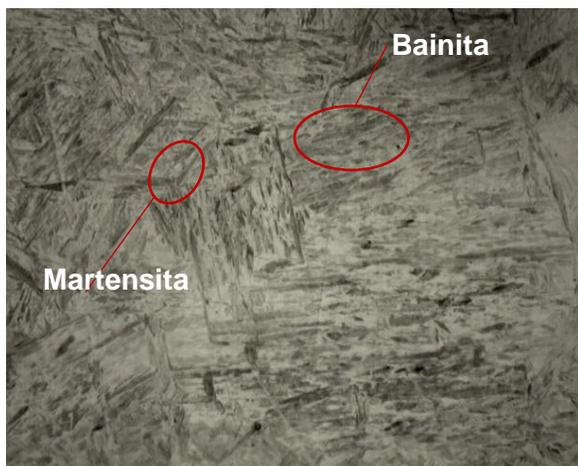
Figura 52 Acero 4140 a 1000X/Nita3%/3s/Nikon. Colonias de martensita y bainita.
