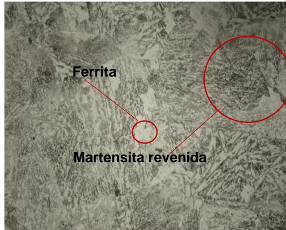
Figura 22. Acero 4140 a 1000X/Nital 3%/3s/Nikon. Región oscura de martensita revenida y clara de ferrita.
