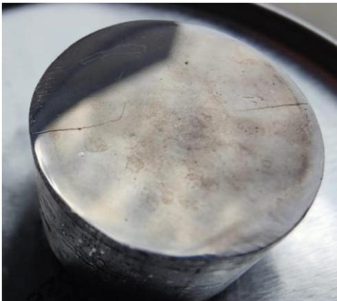
Figura 50. Acero 4140 a 30X. Grietas en la pieza después del temple.
