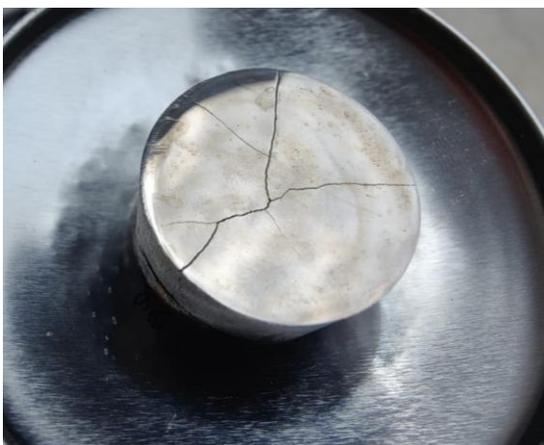
Figura 40. Acero 4140 a 20X/Nital3%/3s/Keyence. Fracturas en la pieza
