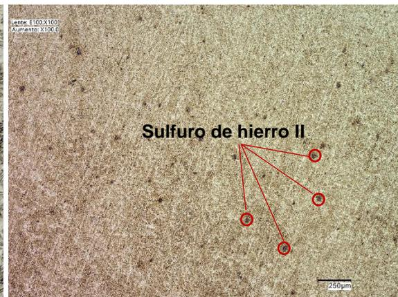
Figura 32. Acero 4140 a 100X/Nita3%/3s/Nikon. Puntos negros de sulfuro de hierro II.
