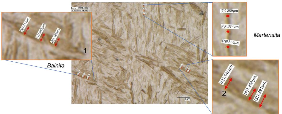
Figura 29. Acero 1045 a 6000X/Nital 3%/3s/Keyence. Medición de tamaño de la martensita y bainita.
